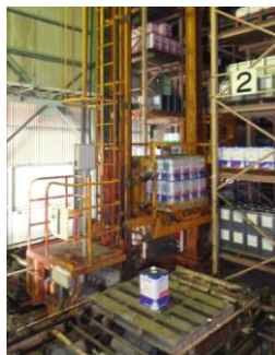
自動ラック倉庫
