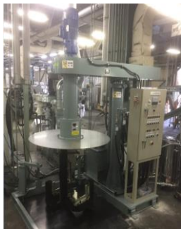
タンク洗浄設備
